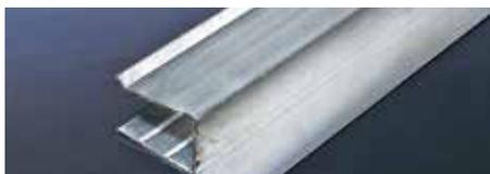
Profilo di alluminio estruso di 2,00 m di lunghezza. Studiato per il taglio del pannello per la sua piegatura a giunto a sovrapposizione. Spessore approssimativo: 1,1 mm.
